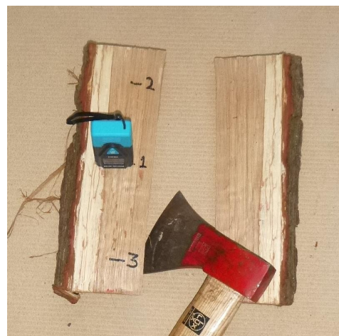
Vochtpercentage van het verse splijtvlak, dwars op de houtnerf, op deze 3 punten meten
